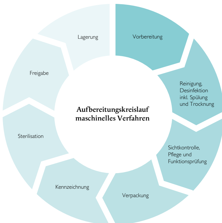
Abbildung 4: Aufbereitungskreislauf maschinelles Verfahren
