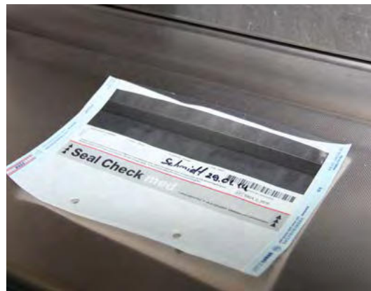
Seal-Check-Test: Beurteilung der Siegelnaht
