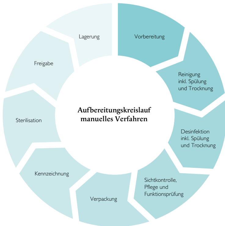
Abbildung 3: Aufbereitungskreislauf manuelles Verfahren
